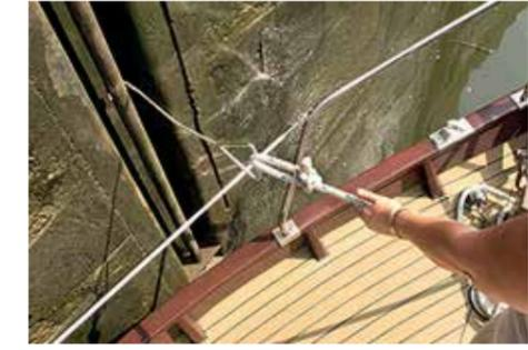
Weit sicherer sind Schleusen haken, deren gebogenes Ende passt um die Haltestangen und gleitet mit dem Boot nach oben oder unten. Bei den Wandhaltern in der Mitte brauchen Sie sich nur noch aus- und gleich wieder einhaken. Wichtig ist, dass der Schleusen haken an einer Leine befestigt wird, die wiederum an einer Klampe oder einem Poller an Bord belegt sein muss.
